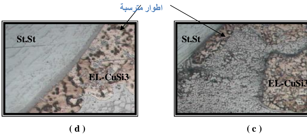
الشكل (26) . البنية المجهرية لوصلات لحام متشابهة ملحومة بطريقة (SMAW) بفتحة لحام (5mm) باستخدام سلك لحام (St.St-d X70 (St.St-St.St)-c X180 (C.St-C.St)-b X70 (C.St-C.St)-a EL-CuSi3) . X180 St.St)
