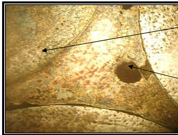
الشكل (13) . مقطع عرضي نموذج أسلاك الفولاذ الملحومة بطريقة المونة وبمعدن حشو BCuP_1 قوة التكبير X125 .
