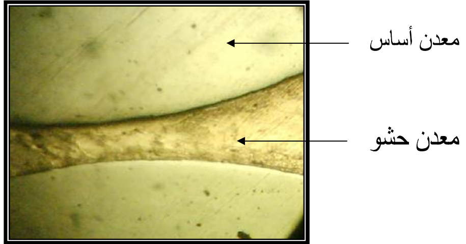
الشكل (10) . مقطع طولي نموذج أسلاك الفولاذ الملحومة بطريقة المونة بمعدن حشو BCuP 1 قوة التكبير X125 .
