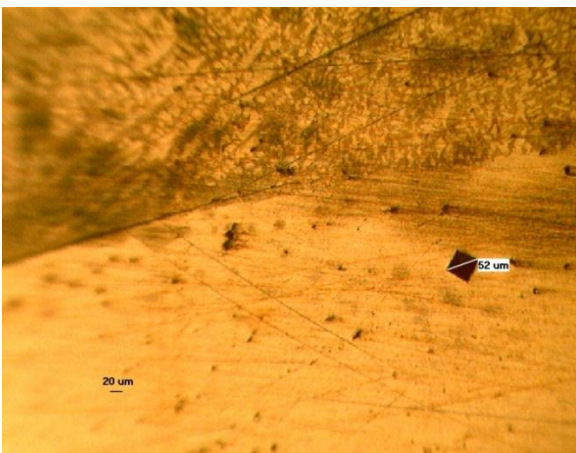
شكل (٦) صور فحص البنية المجهرية لمناطق مختلفة من وصلة اللحام بدون مادة مائة
