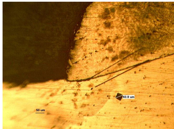
شكل (٦) صور فحص البنية المجهرية لمناطق مختلفة من وصلة اللحام بدون مادة مائة
