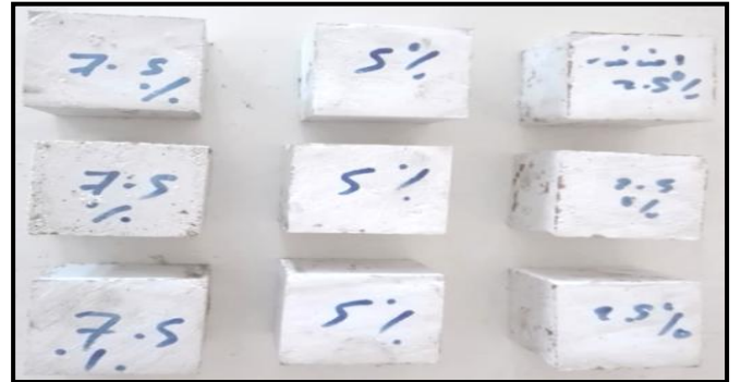
صورة رقم (٢) توضح جزء من مكعبات الجص قبل بدأ فحص مقاومة الانضغاط.
