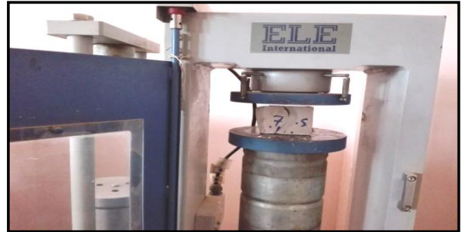
صورة رقم (٣) توضح احد المكعبات أثناء فحص الانضغاط.
