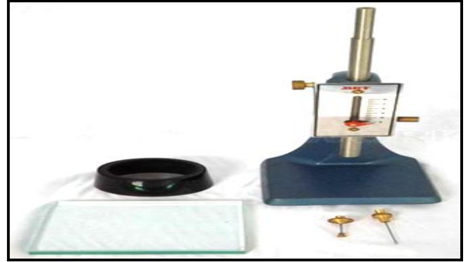
صورة رقم (١) توضح أجزاء جهاز فيكات (Vicat apparatus) المستخدم في تعيين زمن التماسك للجص.
